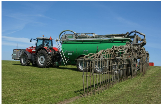
Foto 2. Biocovers SyreN-system med frontmonteret syretank. (foto: Torkild S. Birkmose, Agro Tech).
